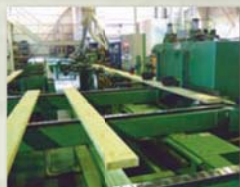
モルダー 単板の厚み・仕上げ分の厚みを考慮した規格寸法で切断。
