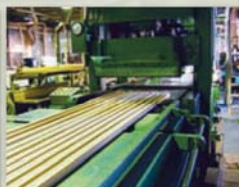
ホットプレス 芯材と単板を接着剤で貼り、プレスする。
