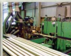
耳とり機 芯材より単板が出ている部分を削り、同じ寸法にする。
