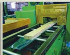
自動梱包 水分・酸素・光など劣化原因となるさまざまな要因から保護するため梱包する。
