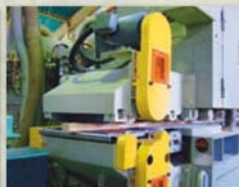
サンダー 長辺・短辺を規格通りに研磨する。
