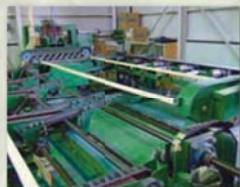
横きり機 長さを規格寸法に切断。
